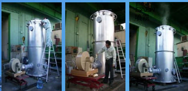
実機（脱臭塔）試験装置
